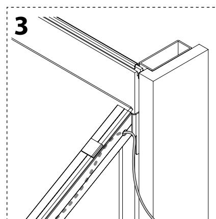
Uscire con il cavo dal foro laterale del montante vetrina (part.3) oppure dal foro realizzato appositamente sullo schienale (ISTR.137.1).
